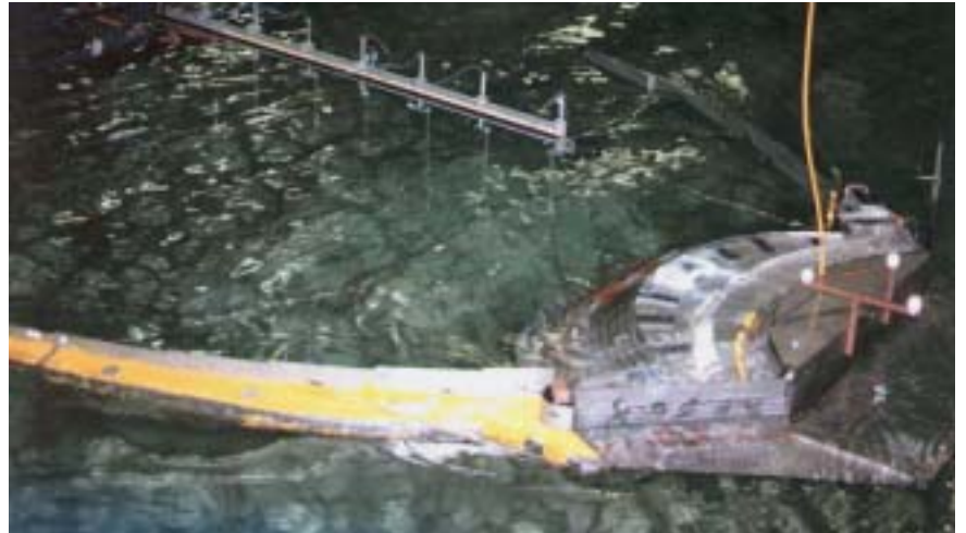
Wave Dragon, et overskylningsanlæg, under test.
