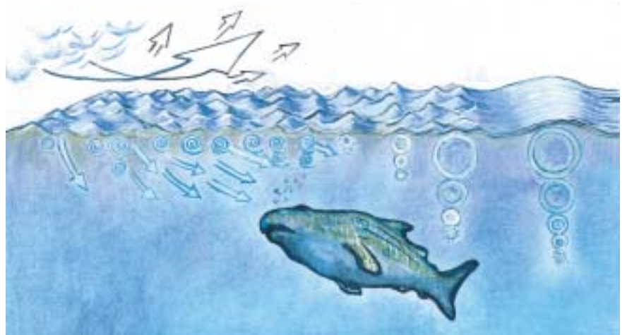
Figur 1. Når vinden blæser over en havoverflade skabes krusninger, som vinden kan overføre sin energi til. Hvis vindens blæser tilstrækkeligt længe, udvikles der bølger, som udbreder sig i vindretning og som vokser i størrelse, indtil bølgetopene bevæger sig næsten lige så hurtigt som vinden. Størstedelen af energien findes nær ved havoverfladen.
