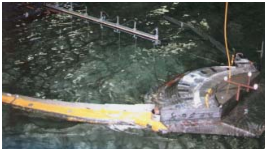
Wave Dragon, et overskylningsanlæg, under test.
